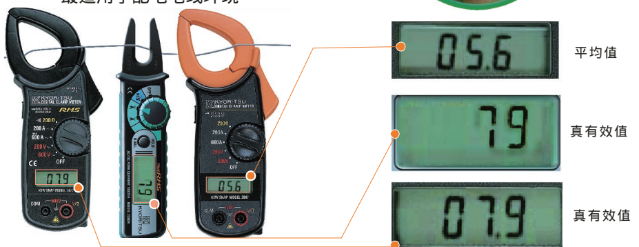
图例：晶闸管控制发动机负荷测试,真有效值测试仪显示7.9A,平均值测试仪显示6.5A。
