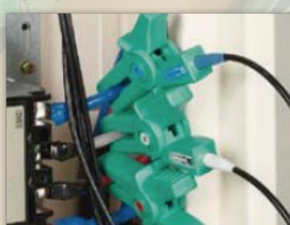
可夹住绝缘电线
